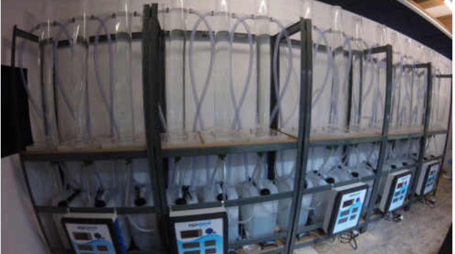
Abbildung: Ansicht der Teststände (Dichtigkeitstest ohne Filtermedien)
