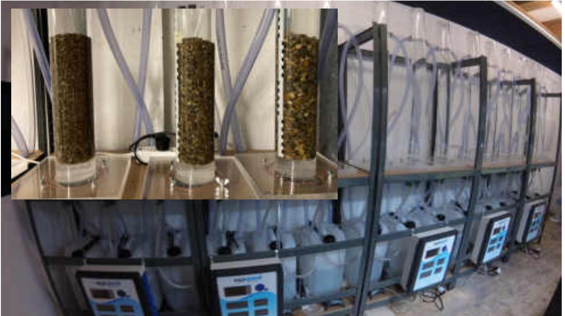
Abbildung: Ansicht der Teststände (Dichtigkeitstest ohne Filtermedien)
